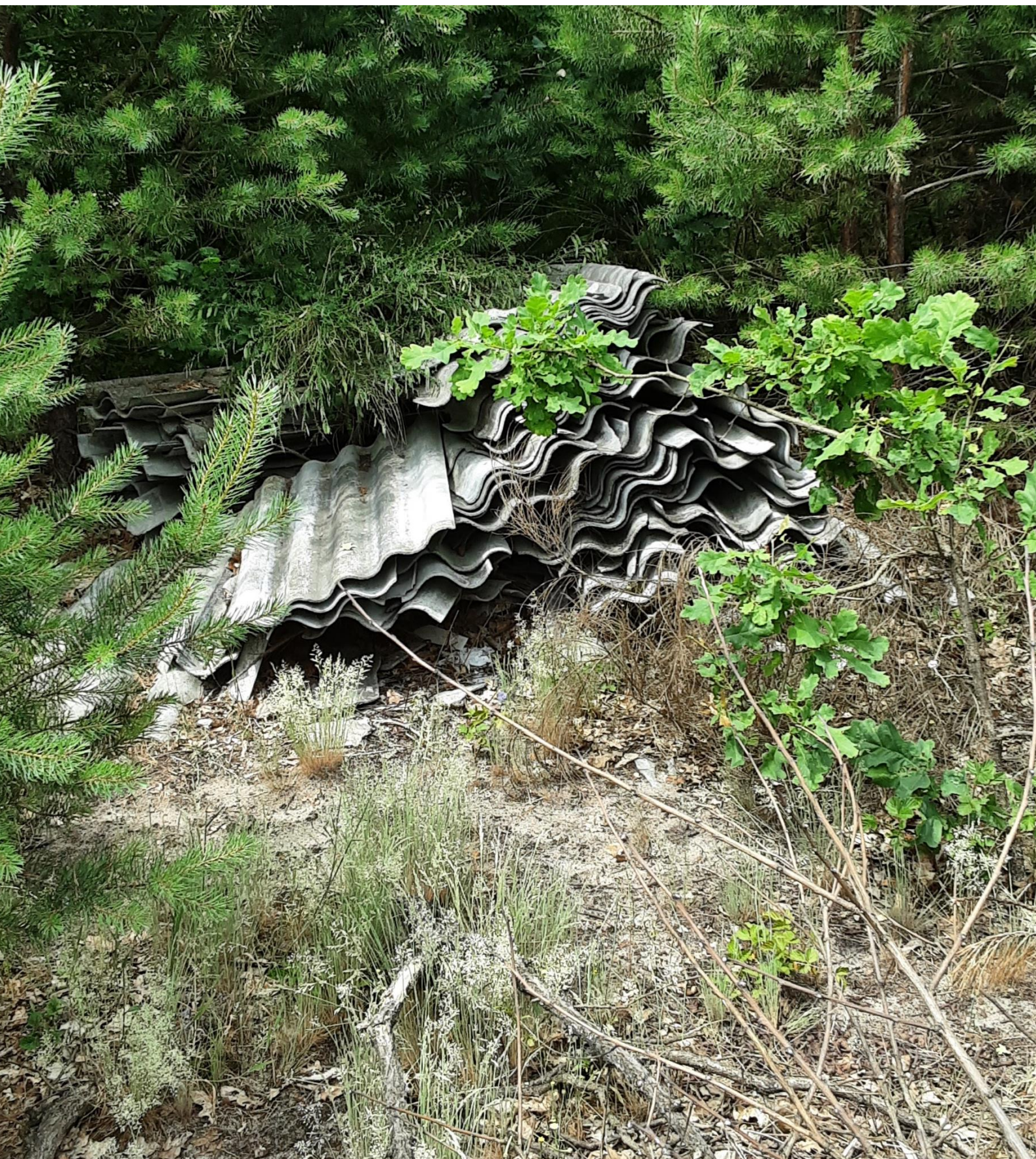
Fot. 2. Nielegalne składowanie wyrobów azbestowych.
